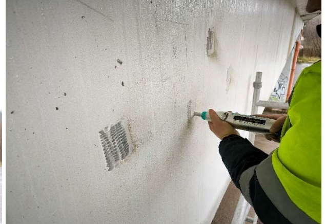
2 pav. Kernų gręžimas perdangos betono gniuždomojo stiprio nustatymui ardančiuoju būdu (a) ir stiprio nustatymas neardančiuoju būdu taikant Schmidt plaktuką (b)
