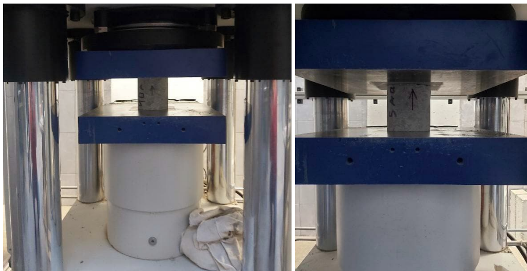
5 pav. Suformuotų betono bandinių gniuždymo bandymas
