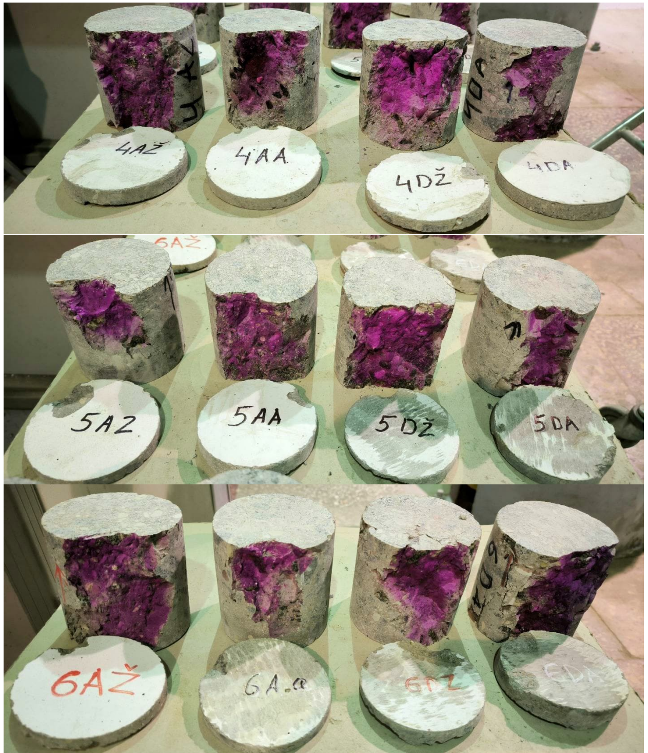
5 pav. Betono bandinių karbonizacijos tyrimai
