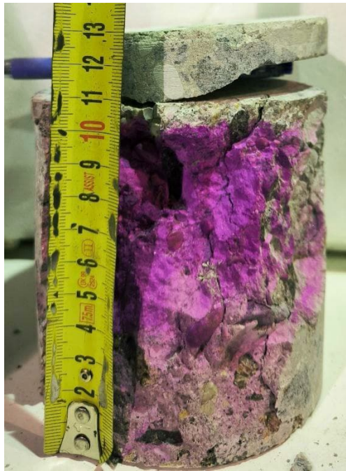
6 pav. Betono bandinio 4Dž karbonizacija bandinio išoriniame paviršiuje
